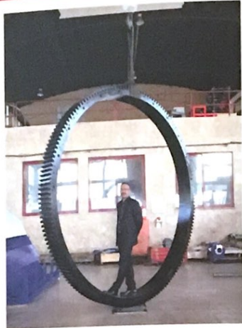
Ø 4000 Özel Dişli İmalatı Ø 4000 Special Gear Manufacturing
