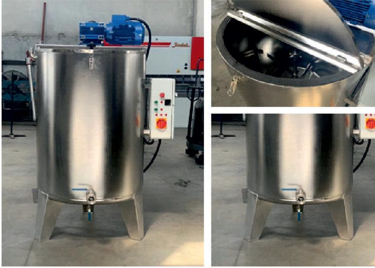
Bütün çikolataların atılıp eritildiği ve karıştırıldığı mikserdir. Ceketli su ısıtmalı olup komple paslanmaz CR-NI malzemeden imal edilmiştir. Kendi elektrik panosu tarafından, bağımsız kumanda edilir ve dijital ısı göstergelidir. 3 yollu vana sayesinde kendi içinde devirdaim ile homojen bir karışım sağlanır ve çikolata kaplama makinesine otomatik transfer yapılır. İç içe geçen çift karıştırıcı sistemi mevcuttur.
