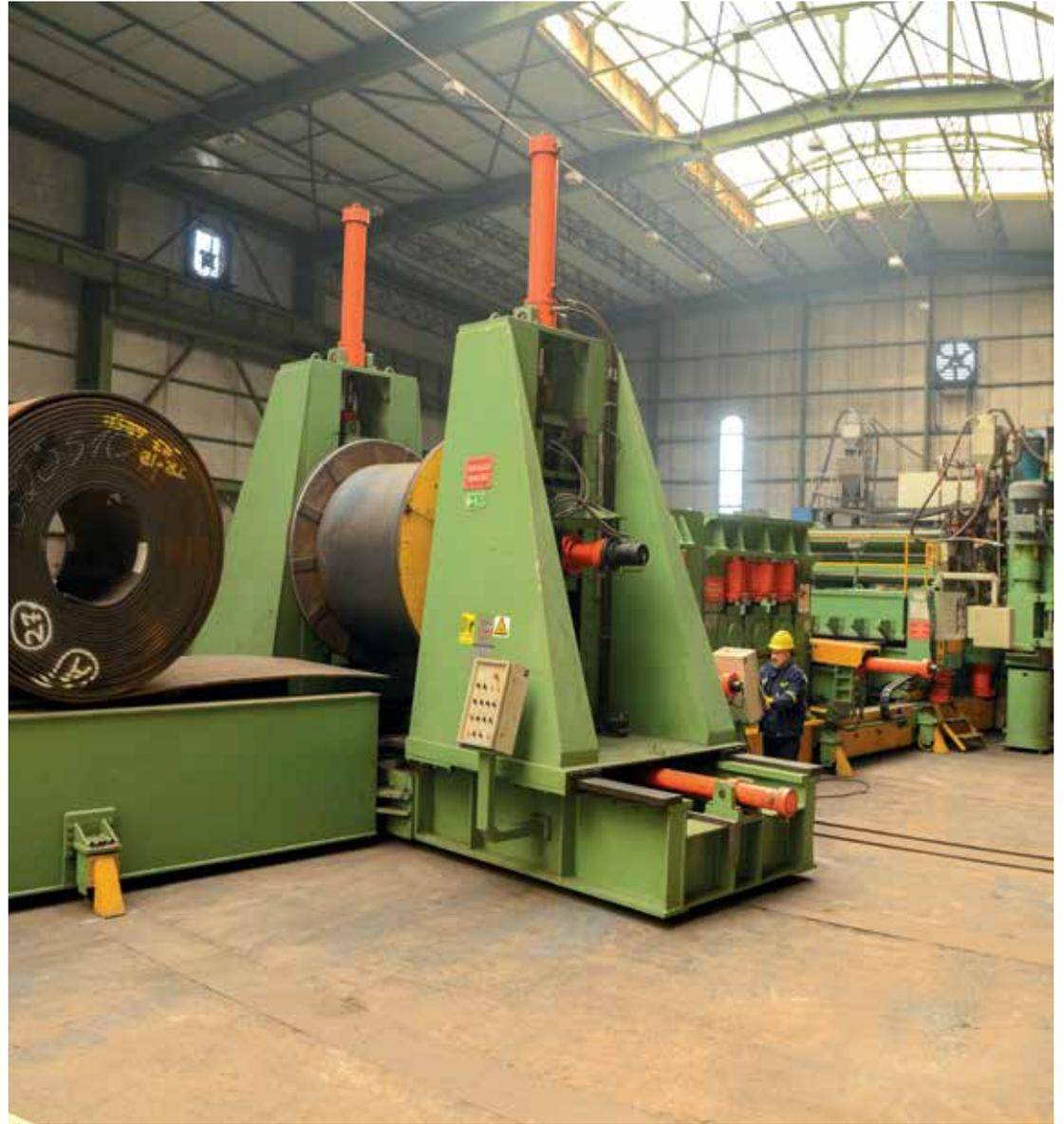
**9000 Ampères et 6 Têtes de Soudage sont utilisés par nos machines pour former et souder les tuyaux.**
