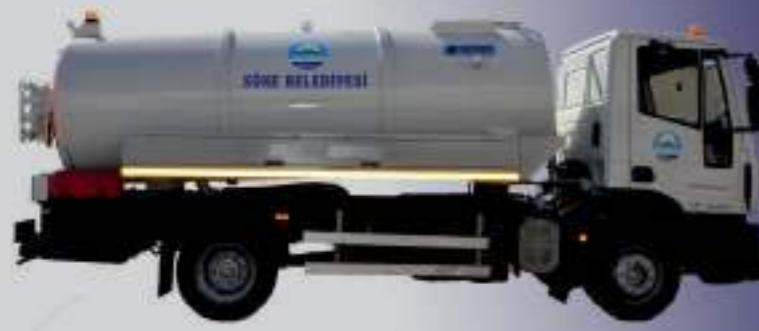
Vakum tankerleri sıvıların, çamur - balıkçık veya foseptik atıklarının emiş hortumları yardımıyla tank içine alınıp taşınması amacıyla kullanılır.
