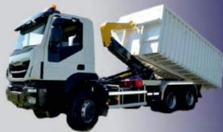
Hooklift üst yapısı özel olarak üretilmiş tekerlekli taşıma konteynırlarını (DIN30722) üzerine monte edildiği araca çekip kaldırarak yüklemek ve istenilen noktaya boşaltmak amacıyla kullanılır. Platform üzerindeki sistem damper görevide görerek konteynir içindeki malzemenin boşaltılmasına yardımcı olur. Ekipman 1 kaldırma kolu, şasi ve hidrolik sistemden oluşmaktadır.
