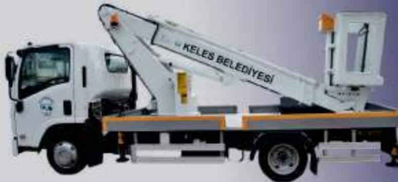
Teleskopik platformlar binaların dış temizliğinde, elektrik hatlarının bakım ve onarımında, inşaat alanlarında, ağaç kesme vb. işlerde kullanılır. Bomlar yüksek dayanıklı özel çelikten imal edilir. Destek ayakları seri açılır sistemle dizayn edilmiştir. Hidrolik ve elektrik sistem için güvenlik paketleri mevcuttur.
