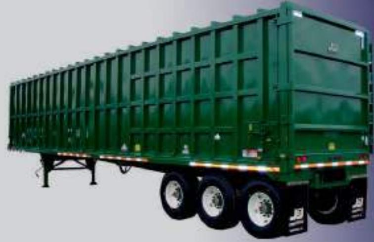
Çöp semi-treylerleri çöpleri ekonomik biçimde atık toplama sitelerine taşımak amacıyla kullanılır. Çöp toplama araçlarıyla toplanan atık ve çöpler, bir istasyon yardımıyla semi-treylere transfer edilir. 10-15 adet çöp toplama aracının taşıyacağı çöpü bu treyler tek seferde ve kolay bir şekilde taşıyıp boşaltabilir.
