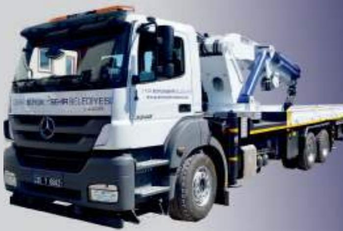
Araç arkasındaki kasa ile araç kabini arasına monte edilen kırmalı vinçler, talebe göre istenilen tonajlarda üretilmektedir. Vinç ile kaldırılan ağırlıklar kasa üzerine konularak istenilen konuma nakledilir. Vinç 2 adet destek ayağına sahiptir ve 360 derece dönme kapasitesine sahiptir. Kullanılmadığında kırılıp katlanarak kasada az yer kaplar ve nakliye aracı olarak kullanılamaya da elverişlidir.
