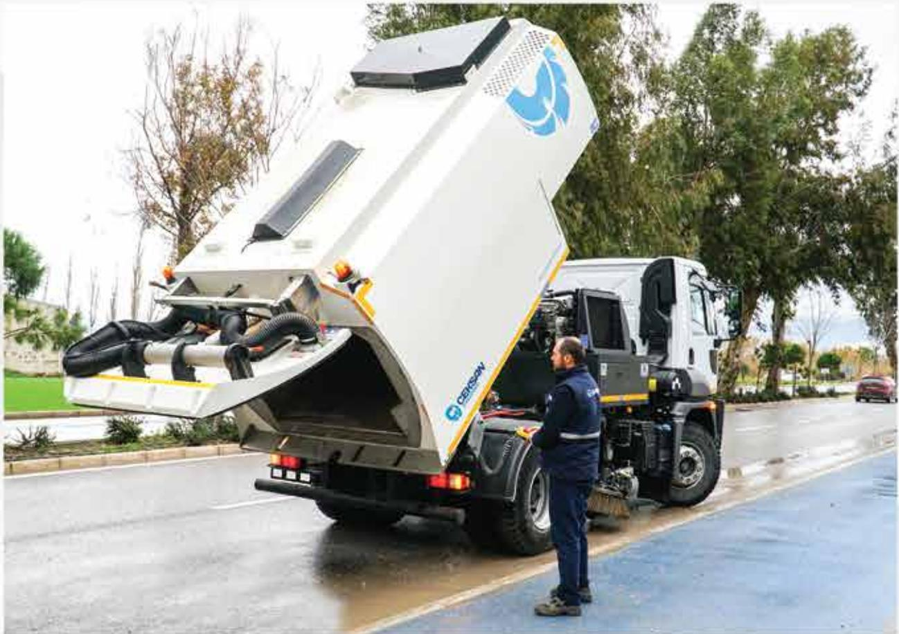
**Déchargement:** Grâce à la conception esthétique de la coque avec l'angle de montée à 55 ° de déchargement, les débris de la poubelle à l'intérieur de la trémie sont complètement sûrs et rapides. Dans ce cas, après avoir déchargé le bunker reste propre et complètement libéré du contenu.
