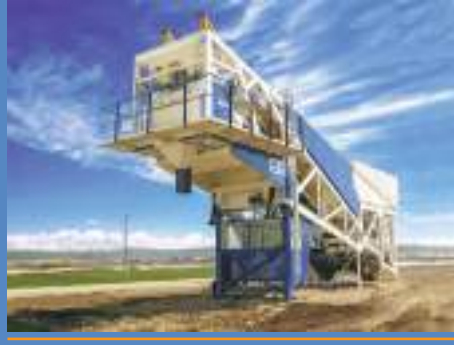
Concrete Plants with Skip Hoist Centrale à béton avec skip
