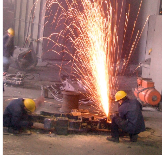
Çapak Temizleme İşleminin Bir Görünümü View From Crust Cleaning Process
