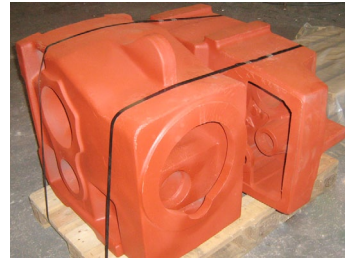
Redüktör Gövdesi Gear Box GG25 735 KG
