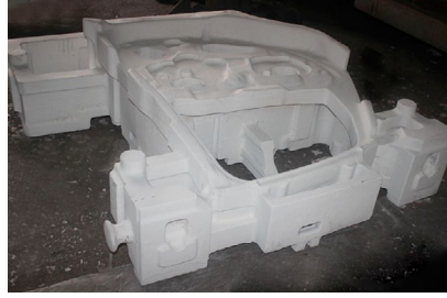
Otomotiv Sac Presi İçin Baskı Kalıbı Stell Casting Die For Automotive Sheet Metal Press G50CRM04 2.000 KG
