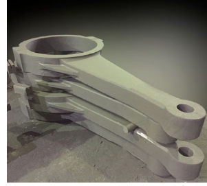
Press Bağlantı Kolu Connect Rod For Press 34CrMo4 1.750 KG
