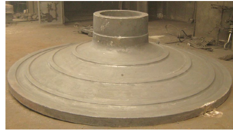
Çap 3800 Değirmen Aynası Diameter 3800 Mill Mirror GGG60 11.000 KG
