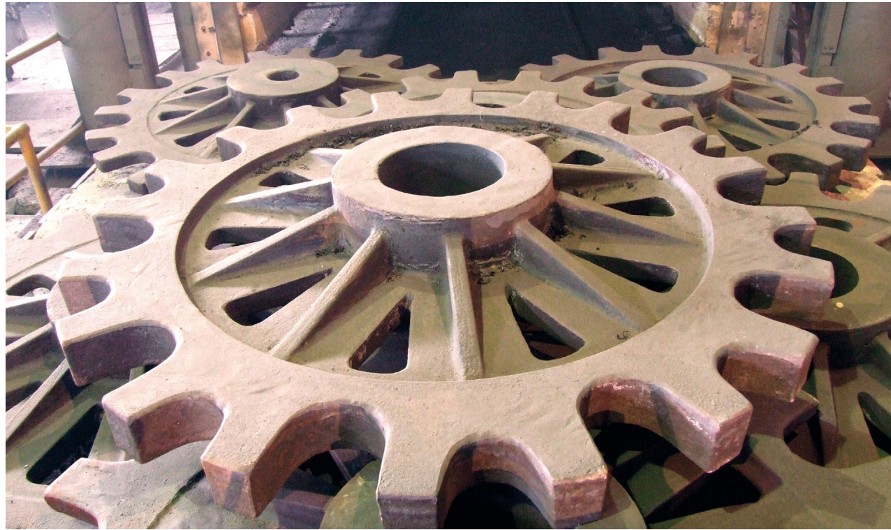
Isıl İşlem Fırınından Bir Görünüm / A View From Heat Treatment Furnace
