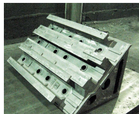
Cnc Tezgah Gövdesi Cnc Machine Body GG25 1.750 KG
