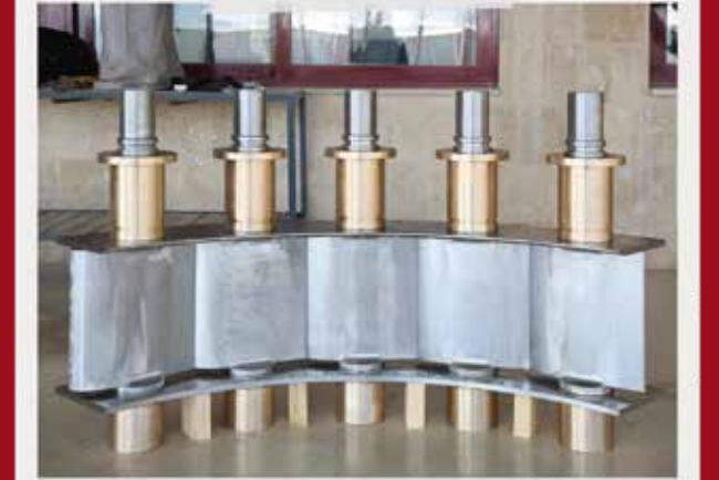
Türbin Kapak İmalatı / Turbine Gate Manufacturing
