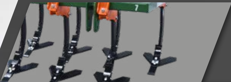
Стойки длинного типа со срезным болтом
