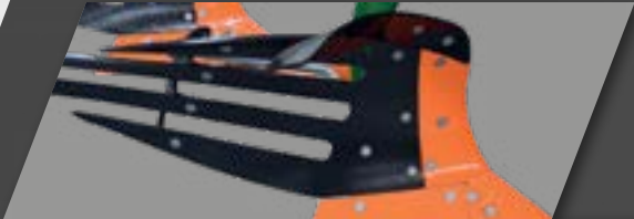
Опционно гидравлическая настройка рабочей ширины
