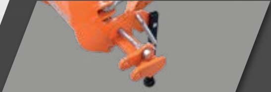
Регулируемый кривошипно-шатунный механизм
