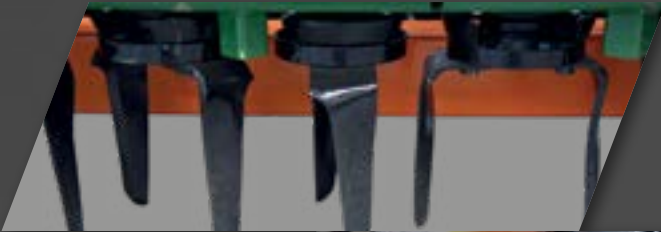
Долговечные ножи, препятствующие налипанию почвы
