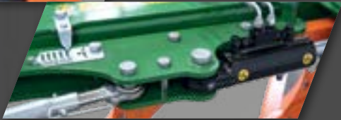
Опционно гидравлическая настройка рабочей ширины
