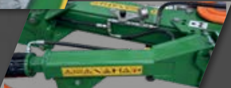
Непрерывное вспахивание благодаря наличию поршневых механизмов
