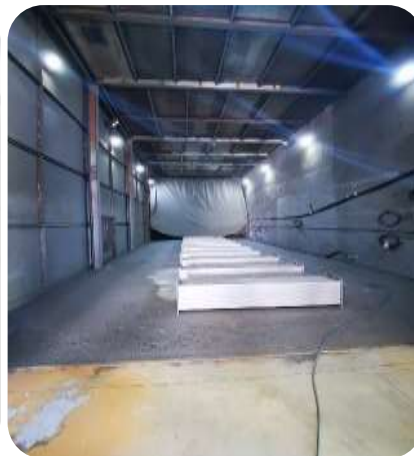
Gritblasting Room W: 7 m H: 6 m L: 20 m
