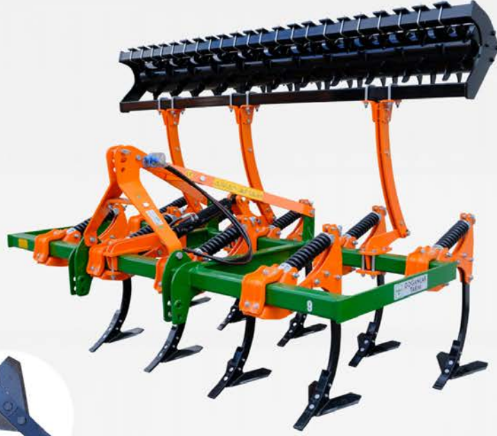
Geliştirilmiş çift tarafı kullanılabilen yılan dili bıçak yapısı
