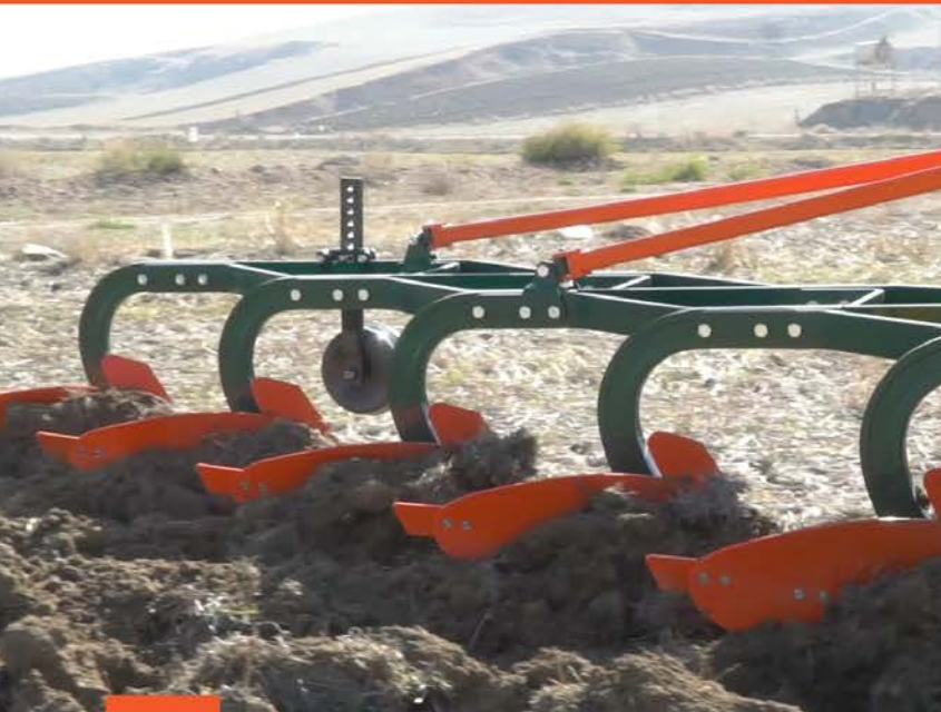
Minimum toprak yapışma, Düşük beygir isteği ile ızgara kulak opsiyonu
