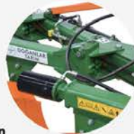
Hidrolik piston mekanizması ile kesintisiz sürüm
